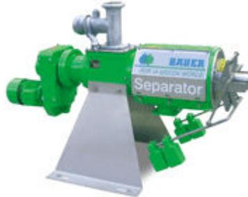
Der Separator S655/S855 von Bauer soll die vollautomatische Trennung von Abfallsubstrat in eine flüssige und feste Phase ermöglichen. Laut Firma ist das System in vielen Branchen einsetzbar. Die 490 kg schwere Maschine soll 10 bis 25 m<sup>3</sup> (S655) bzw. 15 bis 35 m<sup>3</sup> (S855) Substrat in einer Stunde separieren. Die Lagerkapazität des Abfalles bzw. der Gülle solle sich damit um 30% verringern. Nähere Infos auf [www.bauer-at.com](http://www.bauer-at.com)
